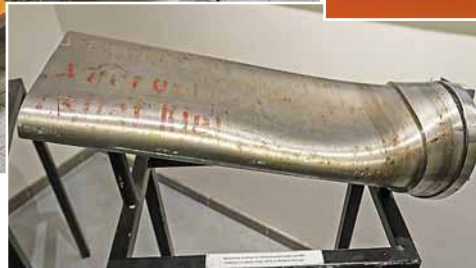
AUV (Autonome Underwater Vehikles (li.), Akustischer Auslöser für Tiefseeverankerungen von AMS. Implosion in 4800 m Tiefe (o.).
